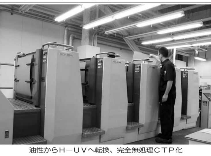
油性からH-UVへ転換、完全無処理CTP化
